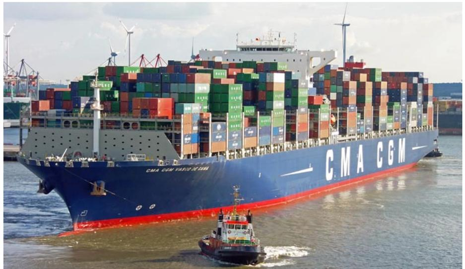
*Containerschiffe mit einer Länge von 400 Metern werden vor dem Einlaufen zu ihrem Liegeplatz im Waltershofer Hafen vor dem Parkhafen gedreht. Bei einer Fahrwasserbreite von 360 Metern ist ein solches Manöver mit äußerster Genauigkeit auszuführen.*
